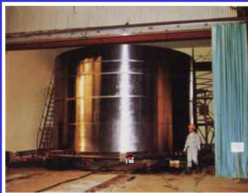
写真4-5 最終検査（超音波探傷検査）
