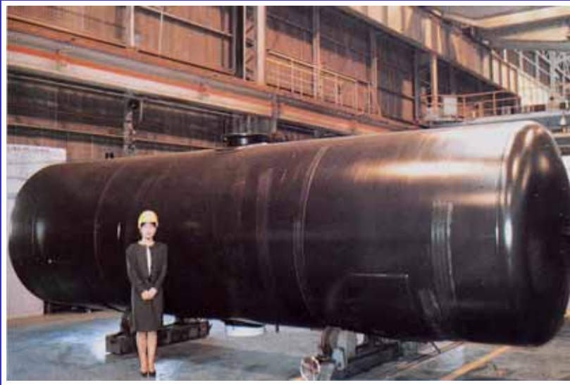
写真2-1 ナトリウム貯留槽(二見工場にて)
